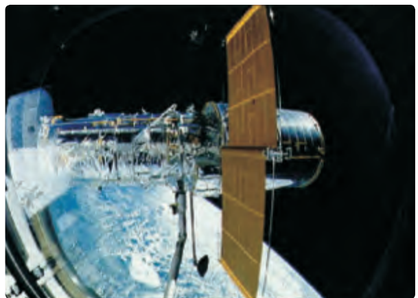
Abb. 8: Das Hubble-Weltraumteleskop (HST) saugt in 600 km Höhe in 100 Minuten einmal um die Erde. Sein Hauptspiegel hat einen Durchmesser von 2,4 m und ermöglicht einen tiefen Blick in den Weltraum. Im Gegensatz zu Teleskopen auf der Erde behindert keine störende Atmosphäre die Sicht.
